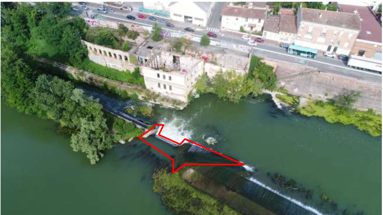
Figure 13 : Zone approximative à démolir
